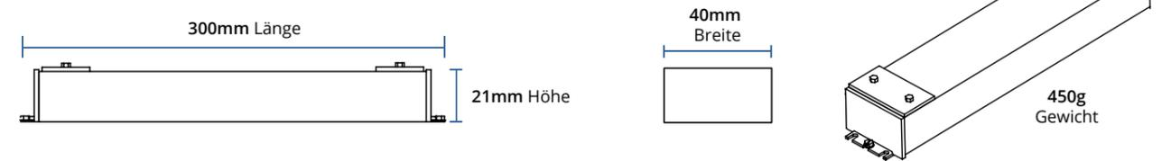
**24VDC LED Treiber 100W IP20 - DALI / DSI / switch DIM / Korridor Funktion**
