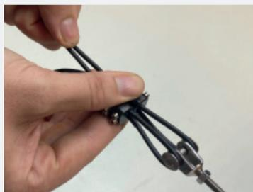
Kabel durch Klemmfixierung ziehen, bis sie straff und gleichmäßig gespannt sind.
