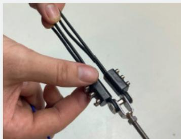
Schieben Sie die Klemmfixierung bis zum Seilspanner.
