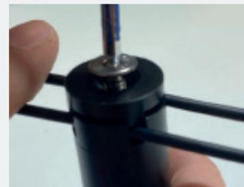
Schrauben Sie die Kappe auf, um die Verbindung zu sichern.
