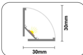
homogene Ausstrahlung mit LED-Band ab 75 LED/m
