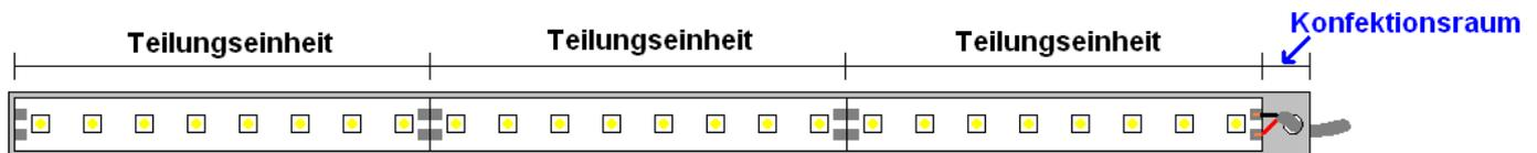
Profillänge= LED-Bandlänge + Konfigurationsraum 1,5cm + Endstücke
